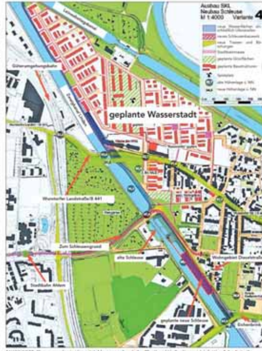
FAVORISIERTE: Planungsvarianten vier mit Schleusenbau (schraffiert) und Verankerung (rot) auf der Deichseite.
